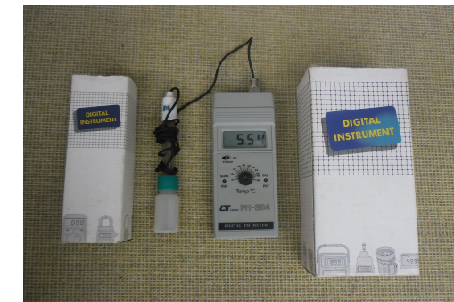
Gambar 4 : pH meter digital, Alat untuk mengukur kadar pH (kemasaman)
