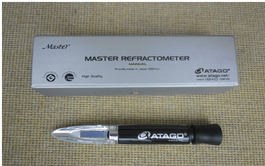
Gambar 3 : Refractometer, Alat untuk mengukur kadar gula
