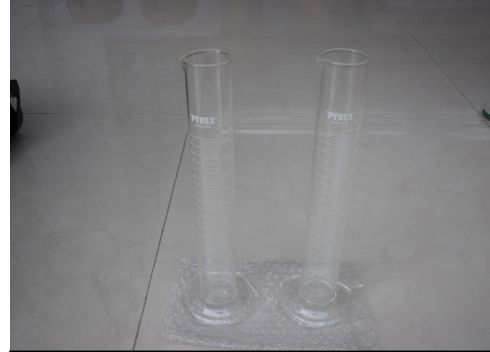
Gambar 2 : Gelas Ukur, Alat untuk menuangkan etanol
