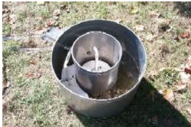
Gambar 8. Infiltrometer double ring yang digunakan untuk mengukur infiltrasi
