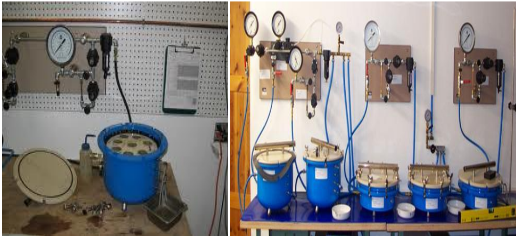
Gambar 7. Pressure Plate yang digunakan untuk mengukur Distribusi Pori
