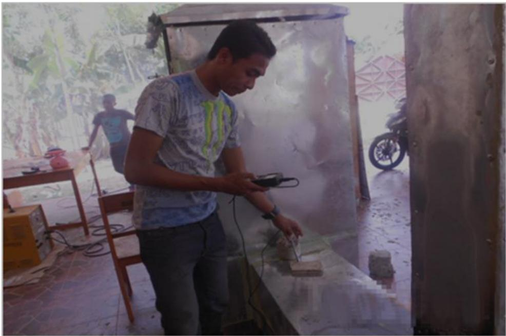
Gambar 8. Mengukur Laju Panas menggunakan Alat Hot Wire Anemometer
