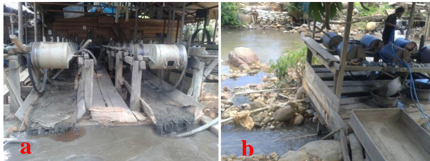
Gambar 1. (a) proses pengolahan emas dengan teknik amalgamasi, (b) pemanfaatan air sungai dalam proses pengolahan emas, Sumber : (a,b) Dokumen pribadi,
