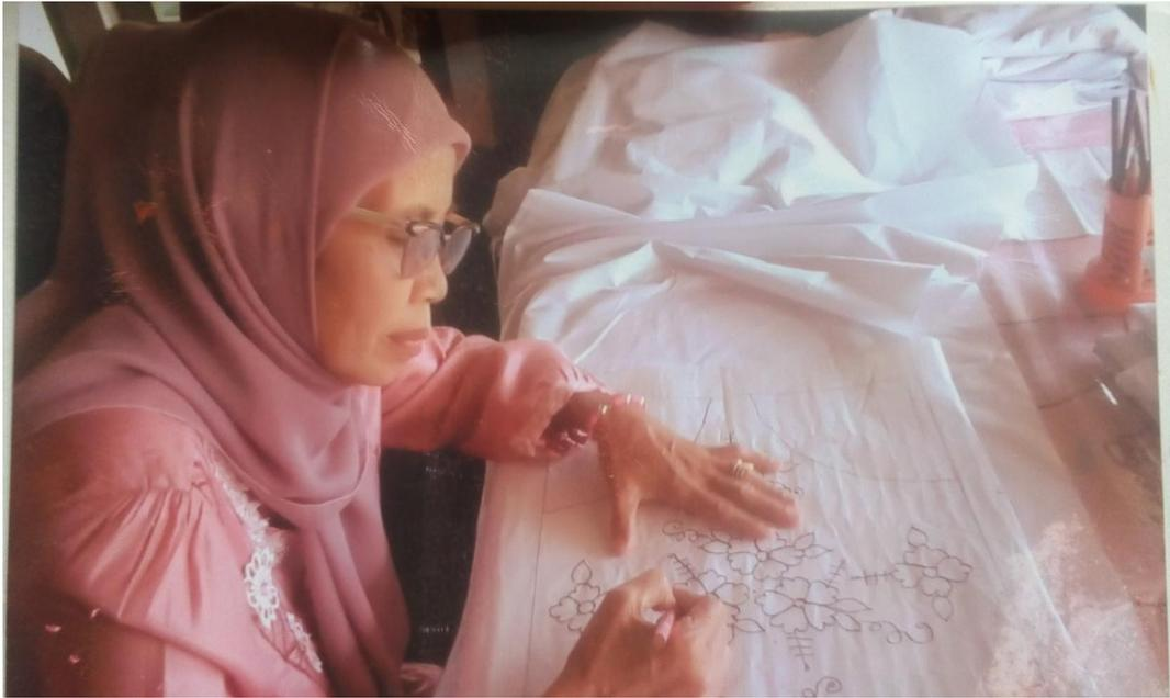
Gambar : pembuatan pola/desain bordir pada kertas foya
