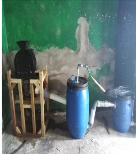
Gambar 3.14. *Reaktor Biogas*
