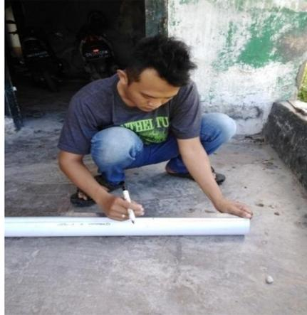
*Gambar 3.3. Pengukuran pipa inlet dan pipa outlet*
