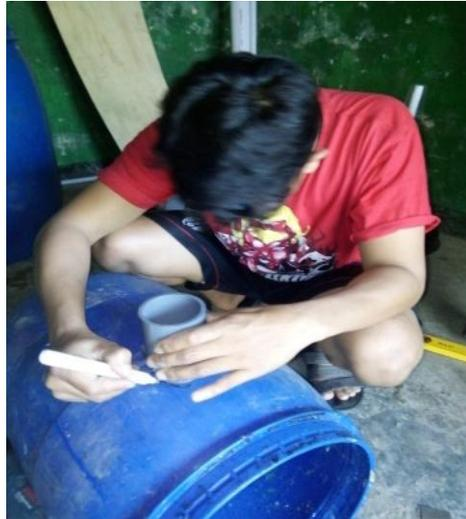
Gambar 3.5. *Pengukuran lubang inlet dan outlet*
