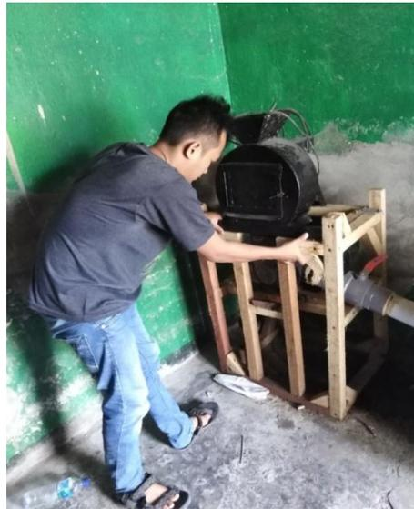
Gambar 3.13. *Pemasangan mesin pencerah sampah organik.*
